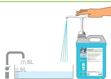
Lors de la première utilisation, retirer la bague d'inviolabilité puis dévisser le bouchon. Fixer la pompe 20mL sur le bidon et l'amorcer. Ne pas utiliser la dose obtenue avant l'amorçage complet de la pompe. À l'aide de la pompe doseuse, diluer le concentré avec de l'eau à température ambiante: 0,4% (4mL/L).
