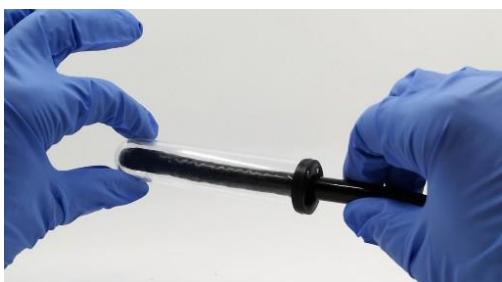
Anschließend wird das Prüfröhrchen zusammen mit dem flexiblen Endoskop in die PT11-Sonde eingeführt, bis sich sowohl das Röhrchen als auch das Endoskop nicht mehr bewegen können. Siehe Bild unten. Achten Sie bei der Messung selbst darauf, das flexible Endoskop zentriert zu halten und ein Herausrutschen des flexiblen Endoskops aus dem Prüfröhrchen zu vermeiden.
