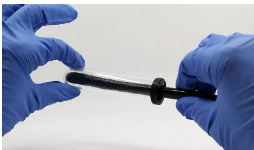
Le tube de test et l'endoscope flexible sont ensuite insérés dans la sonde PT11 jusqu'à ce que le tube et l'endoscope ne puissent plus bouger. Voir l'image ci-dessous. Pendant la mesure elle-même, veillez à ce que l'endoscope flexible reste centré et à ce qu'il ne glisse pas hors du tube d'essai.
